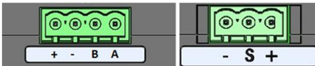
Рисунок 39 – Схема подключения газоанализатора SIGNAL
