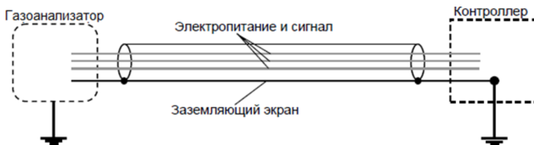
Рисунок 40 – Заземление экранированного кабеля
