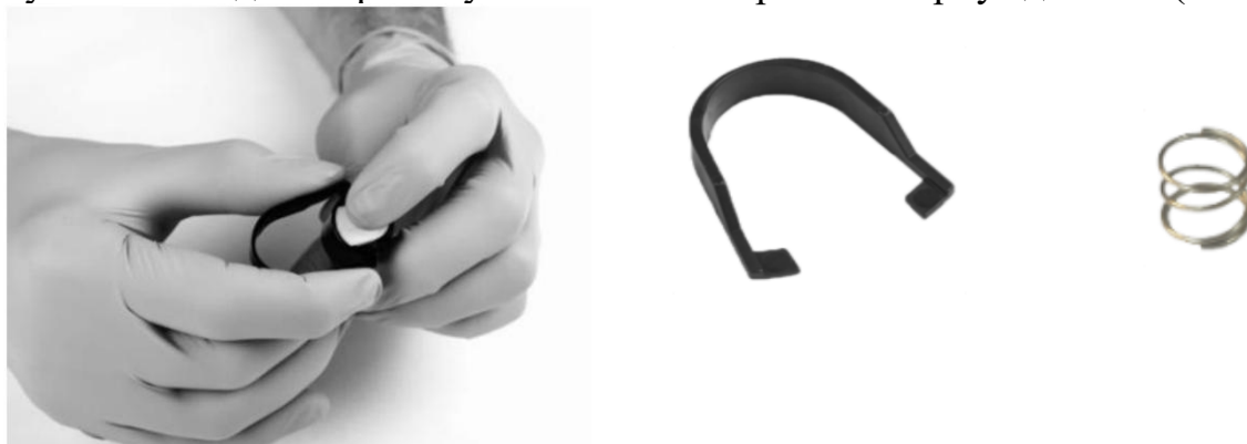
Рисунок 45 – Приспособление для снятия набора электродов, сменная пружина Осмотр набора электродов MX-PID-4S:
