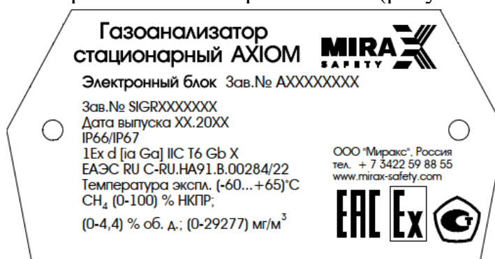
Рисунок 6 – Маркировочная табличка электронного блока газоанализатора AXIOM
